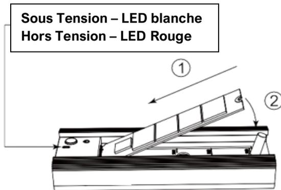
1. Lorsque la LED est rouge, l'appareil est hors tension. Si elle est blanche, l'appareil est sous tension. Veuillez noter que lors de l'installation du SSD M.2, le bouton d'alimentation doit être sur OFF (Indicateur LED rouge) pour éviter tout dommage ou perte de données.
