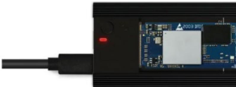
**Le SSD ne peut seulement être installé et retiré lorsque la l'indicateur LED est rouge**
